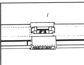
Zuerst weisse Isolierfolie, dann Metallfolie wie gezeigt über Lichtleiter und Halteklemmer kleben (vorher Schutzpapier vom Kleber entfernen).
