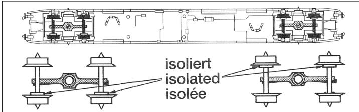
**Achtung!** Radsätze müssen mit ihren grauen Isolierbüchsen entsprechend der Abbildung eingesetzt sein (Kurzschlussgefahr).
