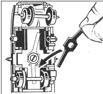
Zum Einsetzen der Stromabnehmerfeder unter die Achsen Zapfenschraube nicht lösen; nur über den Schraubenkopf legen. Je nach Achsstand ist die Stromabnehmerfeder ggf. zu kürzen (bei 4-achsigen Wagen mind. auf der Kupplungsseite). Achsen wieder einsetzen.
