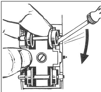
Einen Radsatz durch leichtes seitliches Aufbiegen des Drehgestells entfernen.
