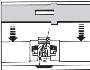
Leiterplatte mit der metallisch glänzenden Leiterbahn zum Lichtleiter hin auf die Halteklemmer aufstecken. Anschlussdrähte müssen in den V-förmigen Kerben liegen bleiben.
